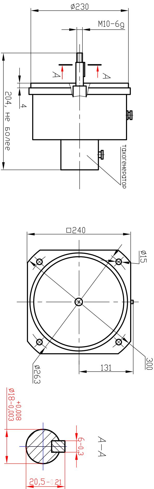
Электродвигатель постоянного тока с независимым возбуждением, с плоским якорем, малоинерционный с высоким быстродействием, предназначенный для привода мехатронных модулей, станков с ЧПУ и промышленных роботов.
